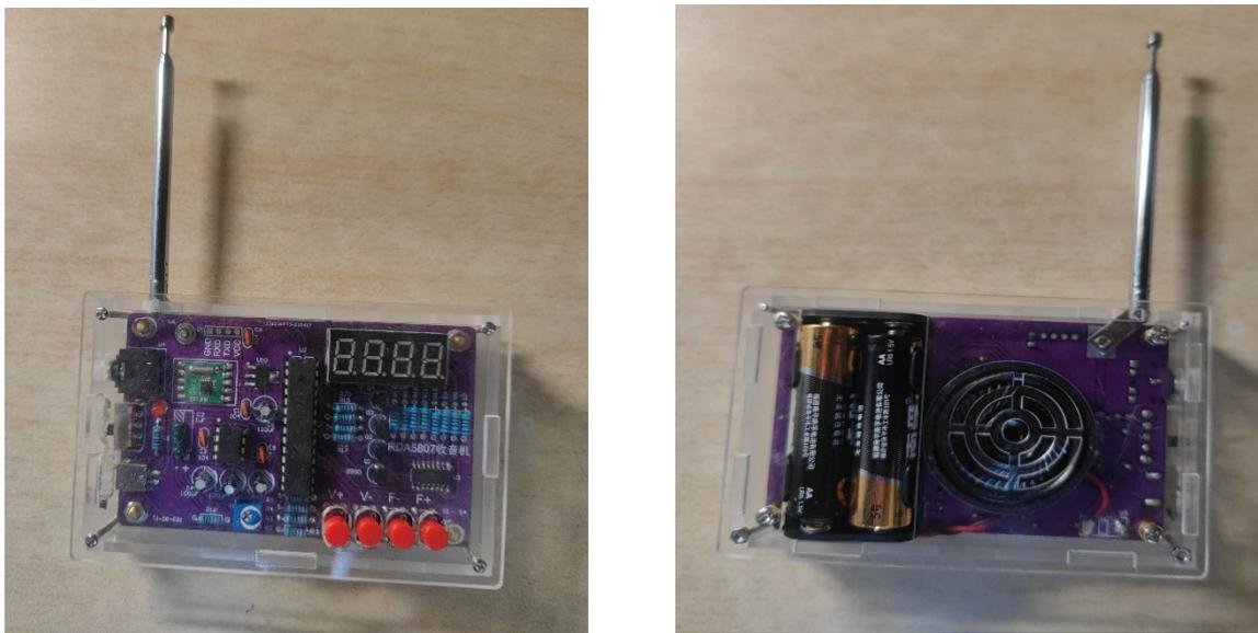
图 10 收音机的整机完成效果图
